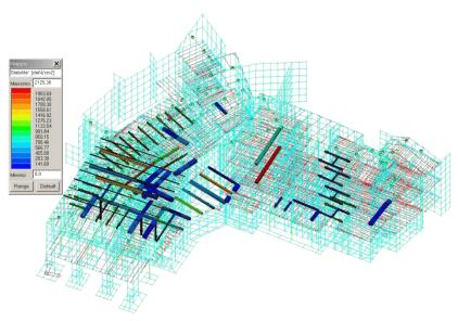
Esempi dei diagrammi di simulazione del comportamento sismico degli edifici prodotto attraverso il **Finite Element Method** (FEM)
